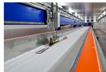
Die Tribometeranlage am Technologiezentrum Ski- und Alpinski ermöglicht Experimente und Tests, die bisher nicht möglich waren.
